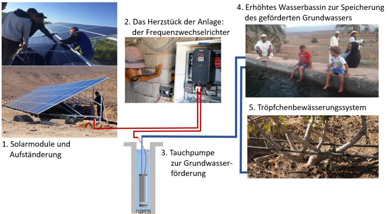
Abbildung 1: Schematische Darstellung der solaren Tröpfchenbewässerungsanlage
